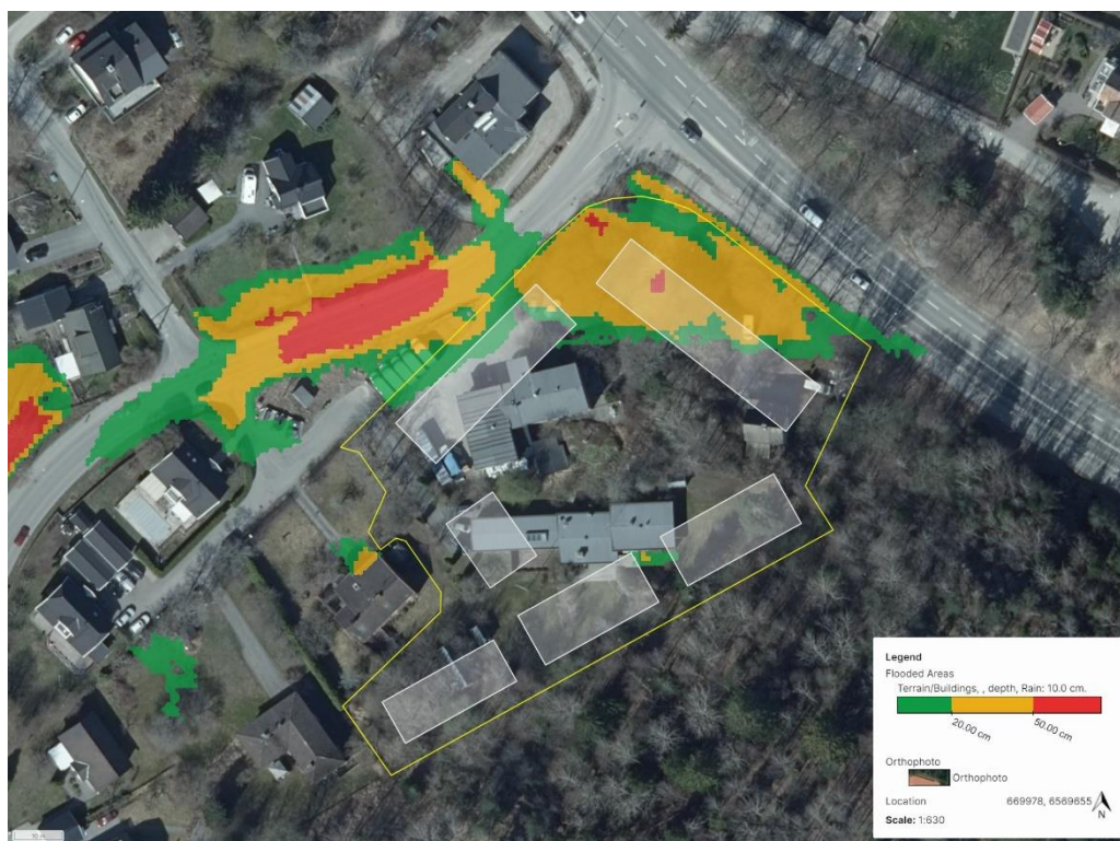
Figur 7. Översvämningsdjup inom DP Laken då 100 mm nederbörd belastas i Scalgo Live. Gul linje representerar detaljplanegräns, och gråvita polygoner representerar placering av framtida byggnader.
